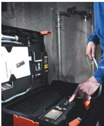
Комплект Pro, цифровой измерительный прибор testo 324, в комплекте с дополнительными принадлежностями
